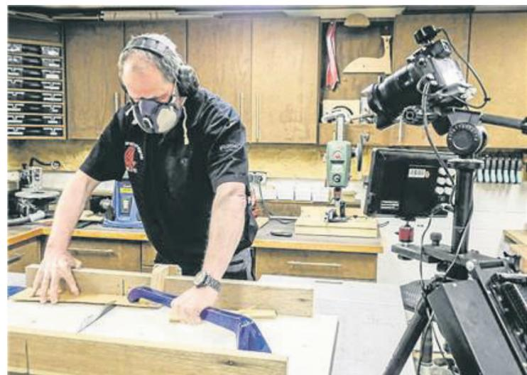
Bei der Arbeit mit der Kreissäge für sein Video trägt Rainer Heymann Ohrschützer gegen den Lärm und einen Atemschutz gegen den Staub.
